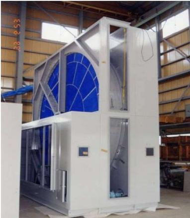
**蜂巢狀沸石濃縮轉輪**之主要材料為玻璃或陶瓷等無機纖維經高溫燒結而成的蜂巢狀基材內塗佈至少50%wt以上之高矽鋁比沸石粉末之吸附劑，可利用該塗佈之沸石特定微孔徑與特性對於半導體、光電業、表面塗裝及印刷業...等主要有機污染物(IPA、Acetone、PGMEA、PGME、Toluene、MEK、Xylene)，具高吸、脫附效率之特性，使原本具高風量、低濃度之VOCs廢氣，經沸石濃縮轉換成低風量、高濃度之廢氣，降低後端終處理設備之成本。
